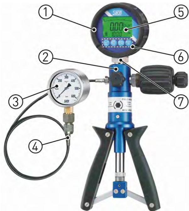
Beispielhafter Messaufbau mit Handpumpe.
